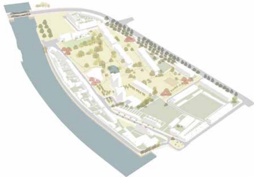
Fase 1 – 2 De aanleg van de publieke ruimte neemt een voorsprong op de vastgoedontwikkelingen. De randparking wordt aangelegd en in het park worden bomen geplant. Vervolgens worden de interne wegen opgebroken en krijgt het park een nieuwe padenstructuur.
